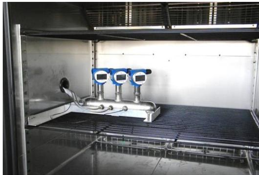
Рис. 4. Внешний вид установки и плотномеров в процессе испытаний.
